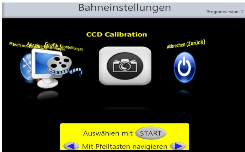
Beide Bahnen müssen im Grundzustand bzw. Im Menü Einstellungen sein, um die Kalibration durchführen zu können. Die Pindeckbeleuchtung eingeschaltet und 10 Pins auf beiden Bahnen aufgestellt.
